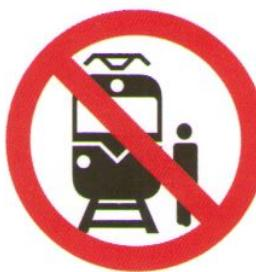
Не переходить железнодорожные пути перед приближающимся движущимся подвижным составом, когда расстояние до него менее 400 м! При пропуске поезда находиться на безопасном расстоянии – не менее 2,5 м от крайнего рельса в сторону обочины, в том числе при проходе поезда по соседнему пути!
